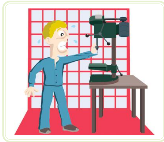
Figura 3.8: Ponto de agarramento em uma furadeira de bancada Fonte: CTISM
